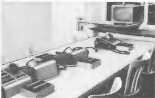
Bild 4. Blick in ein Telefonzimmer mit 36-cm-Monitor und Tastenfeldern für jeden Arbitragisten
